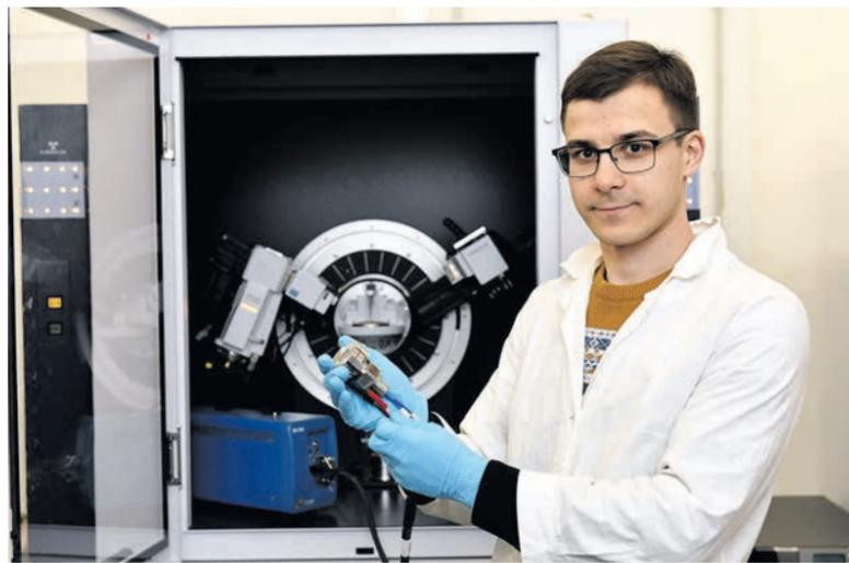
Максим Захаркин подготавливает электрохимическую ячейку для operando эксперимента на рентгеновском дифрактометре
