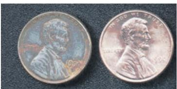
Рис. 5. Монета США (1 цент, 1990) с частично снятым медным покрытием (слева)
