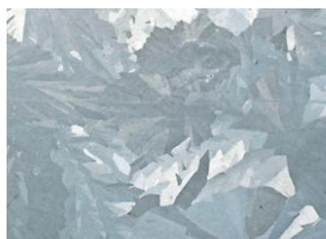
Рис. 1. Кристаллы цинка на оцинкованной жести
