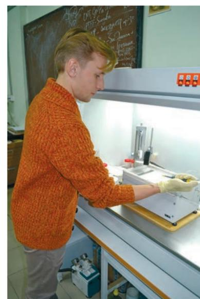
Нанесение графеновых контактов методом Ленгмюра — Блоджетт на подложку из ниобата лития
