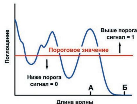
Рис. 3. Пример спектра поглощения и перевод аналогового сигнала в цифровой
