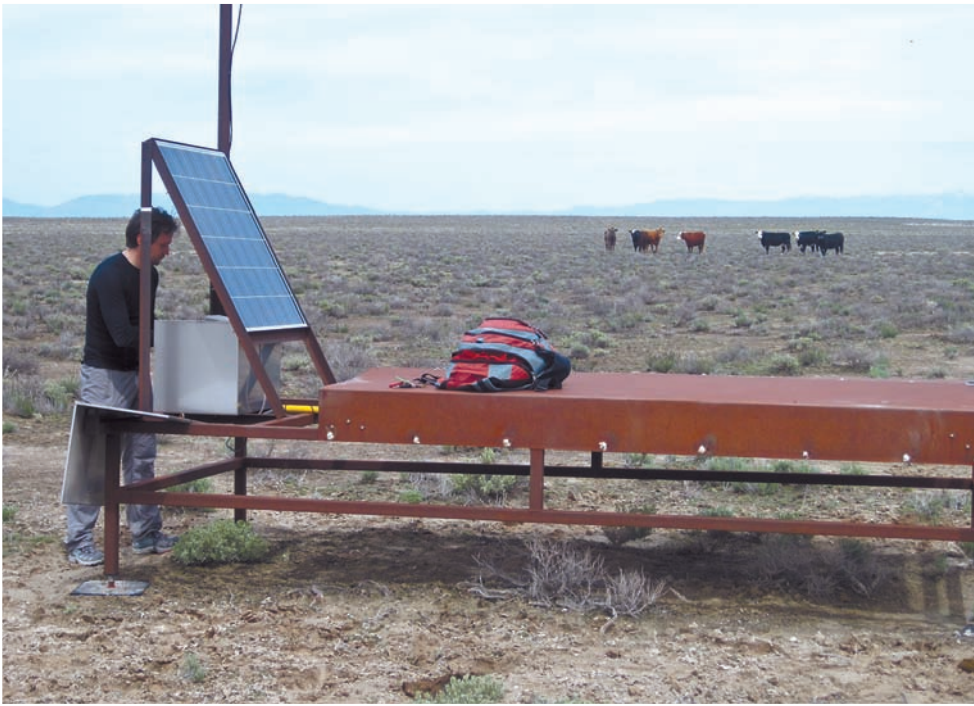
Текущий ремонт сцинтилляционного детектора наземной решетки. Фото О. КАЛАШЕВА
